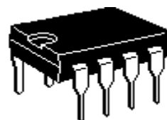
Корпус DIP-8 Типономиналы: КР1033EY15А,Б КР1033EY16А,Б
